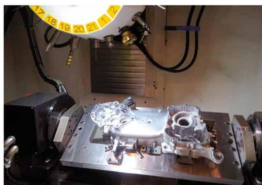
DDR-Ti<sup>®</sup>を使用した割出部品加工
