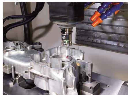
高速スキップを使用した計測の例
